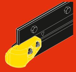
Der Randsteinabweiser wird einfach mit der mit Befestigungslöchern vorbereiteten Schneeräumleiste verschraubt und bietet so optimalen Schutz der Kanten. Aufgrund des gleichmäßigen Verschleißes verlängert sich die Standzeit der Leisten. Ein einfaches Austauschen des Randsteinabweisers ist jederzeit möglich.
