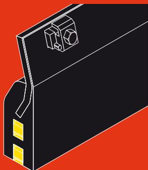
La costruzione caratterizzata da un inserto in ceramica flessibile rende il coltello maggiormente elastico, evitando salti e sbalzi della lama. La parte superiore, dove sono presenti i fissaggi in acciaio è facile da montare e non permette il ribaltamento del coltello.
